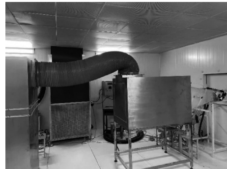
图 10 集成热管理系统实验台
